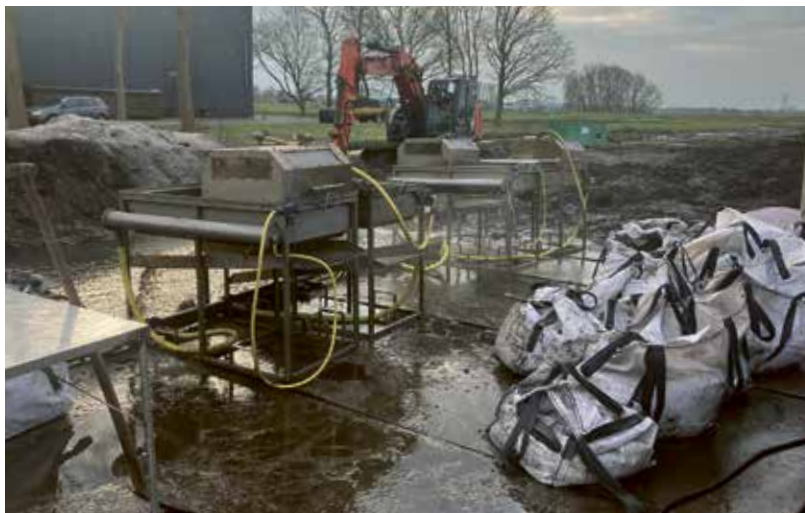
Spoelmachines filteren al het zand en veen uit de grote put.
